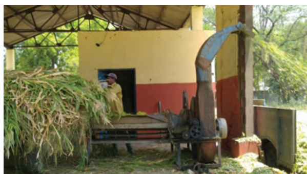
(d) Electrically operated chaff cutter
