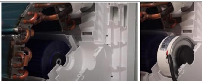
**Fig. 3.21 Replacement of fan blower motor**
